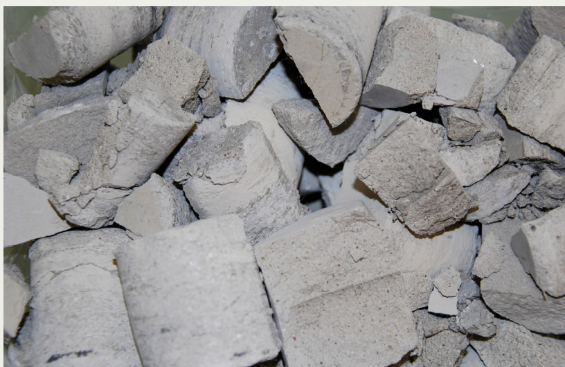
Provtagna borrkärnor för fuktprovtagning.
